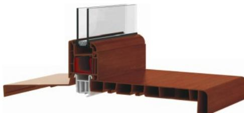
Glaful sau pervazul este montat cu ajutorul unui profil special numit solbanc sau inaltator de glaf. Acesta ajuta la montarea atat a glafului interior din PVC cat si a celui exterior din aluminiu. Dimensiunile glafurilor variaza in functie de grosimea zidului. Glaful interior este la culoarea tamplariei, iar cel de exterior este alb sau maro in standard dar se poate vopsi in camp electrostatic in orice culoare RAL sau in una dintre gamele imitatie lemn.
